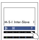
A beltéri egység, slave vagy inter-slave-re konfigurálásához válassza a MSI opciót a menü jelzése szerint. Ezután nyomja meg annyiszor a ↑ gombot, amíg a kívánt jelzés nem látható. Válassza a OK opciót amíg a ① led villog a mentéshez vagy a ✖ a mentés nélküli kilépéshez.
