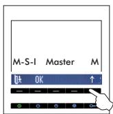
A beltéri egység, master egységgé konfigurálásához válassza az MSI opciót a menü jelzése szerint. Ezután nyomja meg annyiszor a ↑ gombot, amíg a master jelzés nem látható. Válassza az OK opciót amíg a ① led villog a mentéshez vagy a ✖ a mentés nélküli kilépéshez.
