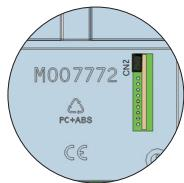
A vonalvég jumper a beltéri egység CN2-es csatlakozón található, mely a beltéri egység hátulján helyezkedik el.
