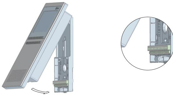
A beltéri egységet, az alaplaptól való leszereléséhez használjon laposfejű csavarhúzót a rögzítő fül kiakasztásához. Húzza a beltéri egységet maga felé az eltávolításához, közben ügyeljen arra, hogy ne sérüljön az eszköz.
